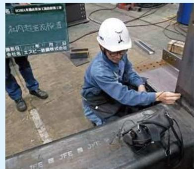
⑥ 製品検査(寸法,UT検査)
